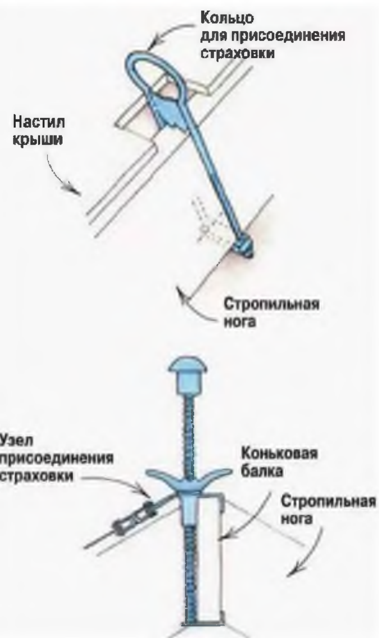
Общий вид крепления страховочных анкеров к стропилам
