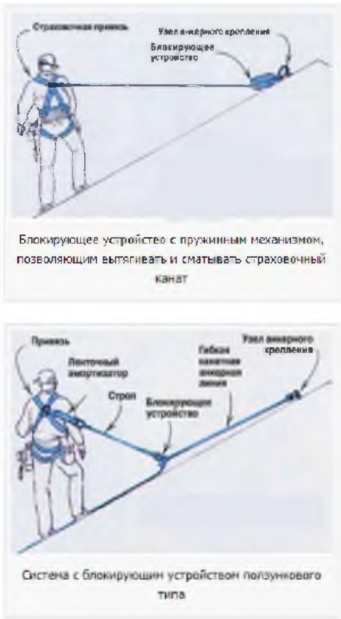
Схемы блокирующих устройств страховочных поясов
