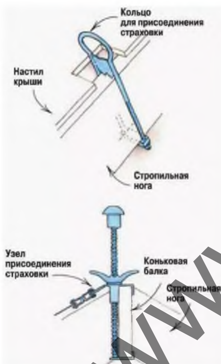
Общий вид крепления страховочных анкеров к стропилам
