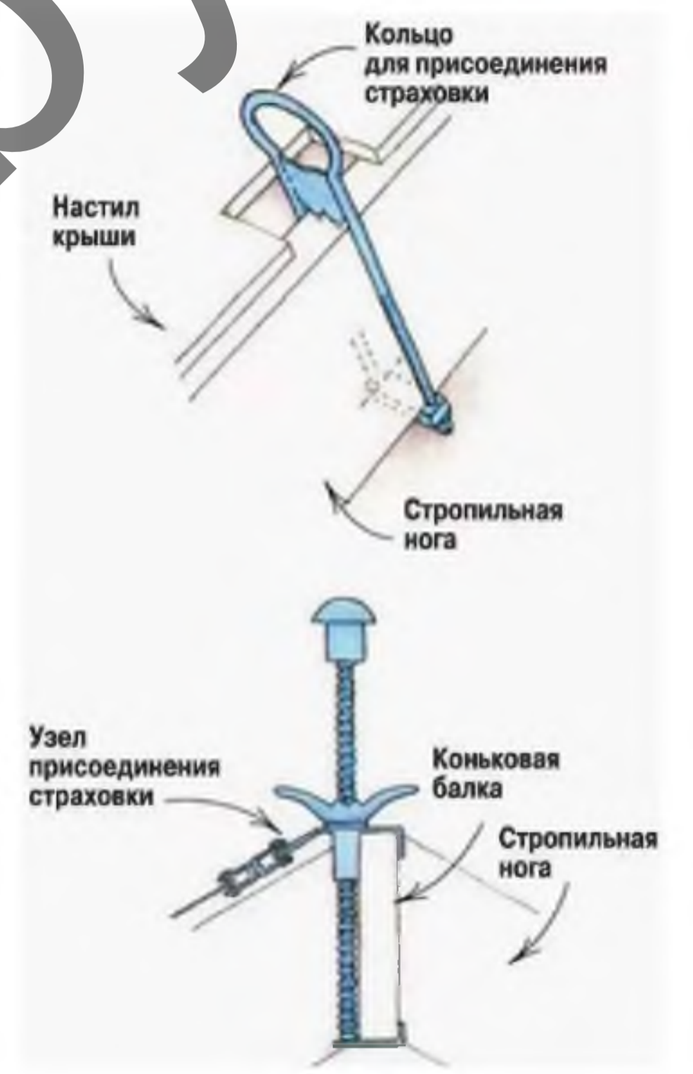
Общий вид крепления страховочных анкеров к стропилам
