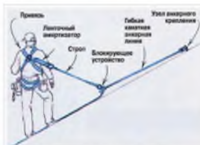
Система с блокирующим устройством ползункового типа
