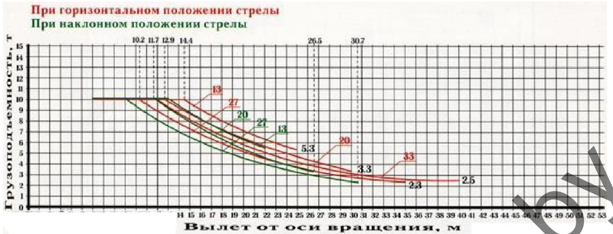
Характеристики башенного крана КБМ401П стрела 40 м горизонтальное положение
