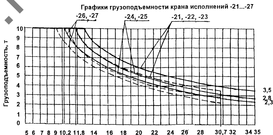
Рис. 7.2.2 Грузовые характеристики крана КБМ401П
