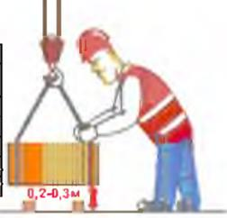
**Схема безопасности при подъеме груза**
