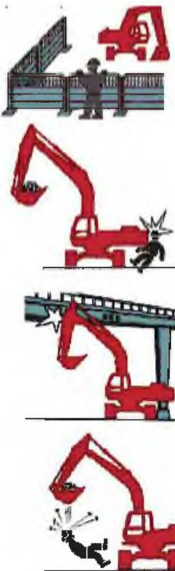
Проверьте, установлено ли сигнальное ограждение рабочей зоны сзади с доков в радиусе действия ковш экскаватора. Если ограждение не установлено, следует его установить!
