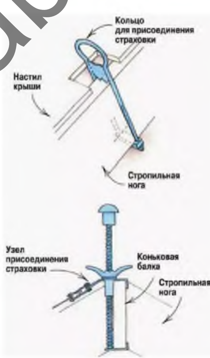
Общий вид крепления страховочных анкеров к стропилам
