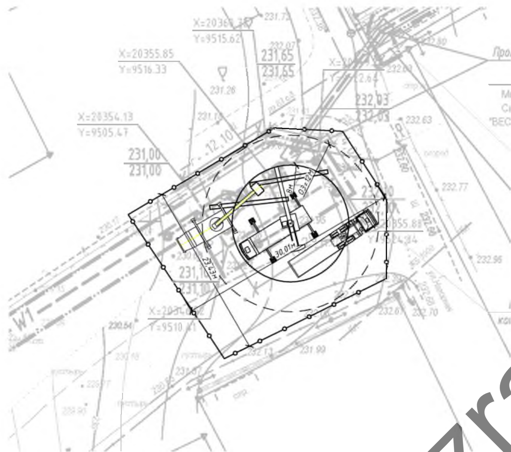
Схема организации рабочего места при монтаже опор
