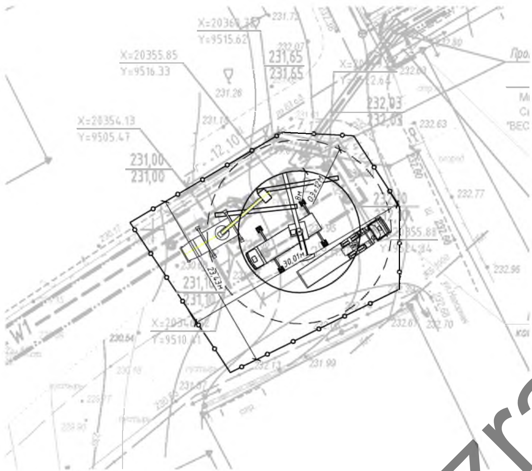
Схема организации рабочего места при монтаже опор
