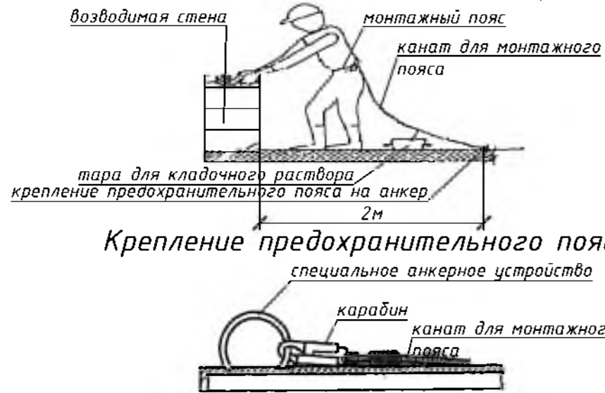
Организация рабочего места при производстве каменных работ
