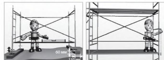
При помощи винтовых опор добейтесь строго горизонтального положения первого яруса лесов
