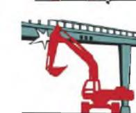
Осмотритесь, нет ли в зоне действия стрелы и ковш экскаватора сооружений и конструкций, препятствующих работе и опасных при соприкосновении с ними.
