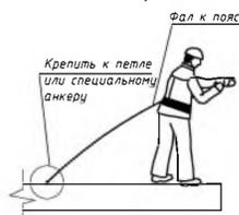
Схема крепления страховочного пояса за несущую конструкцию (колонну)
