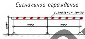
Важно: В период производства работ опасные зоны работы механизмов ограждаются сигнальным ограждением. Также создаются сигнальным ограждением возможные расширения опасной зоны при проведении криволинейных работ со стороны улицы.
