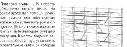
Повторяя этапы III, IV набрать необходимую высоту лесов. На рабочем ярусе при помощи флажковых замков для обеспечения безопасности установить рамы ограждения (8) или горизонтальные связи (5), выполняющие функцию ограждения. В местах подъема рабочих на рабочей ярус, установить горизонтальные связи (5), которые служат ограждением зоны подъема.
