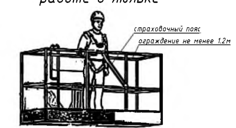
Схема страховки при работе в люльке
