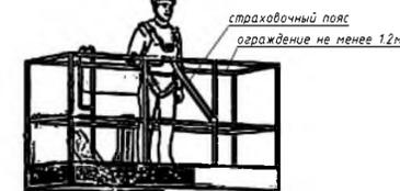
**Схема безопасной работы стропальщиков в период разгрузки строительных материалов и работы краном**
