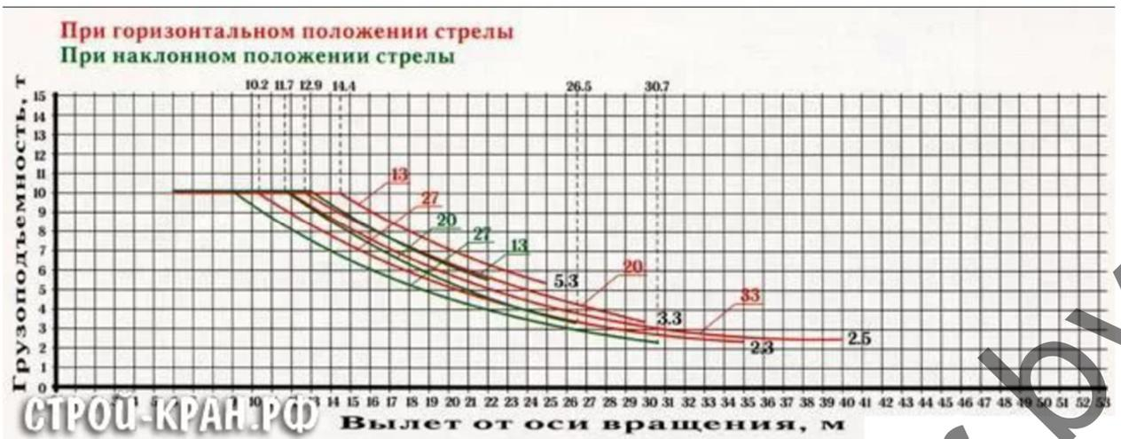
Рис. 7.2.2 Грузовые характеристики крана КБМ401П
