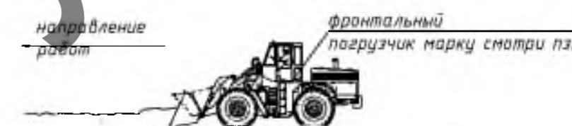
Выемка грунта погрузчиком
