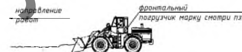
Выемка грунта погрузчиком
