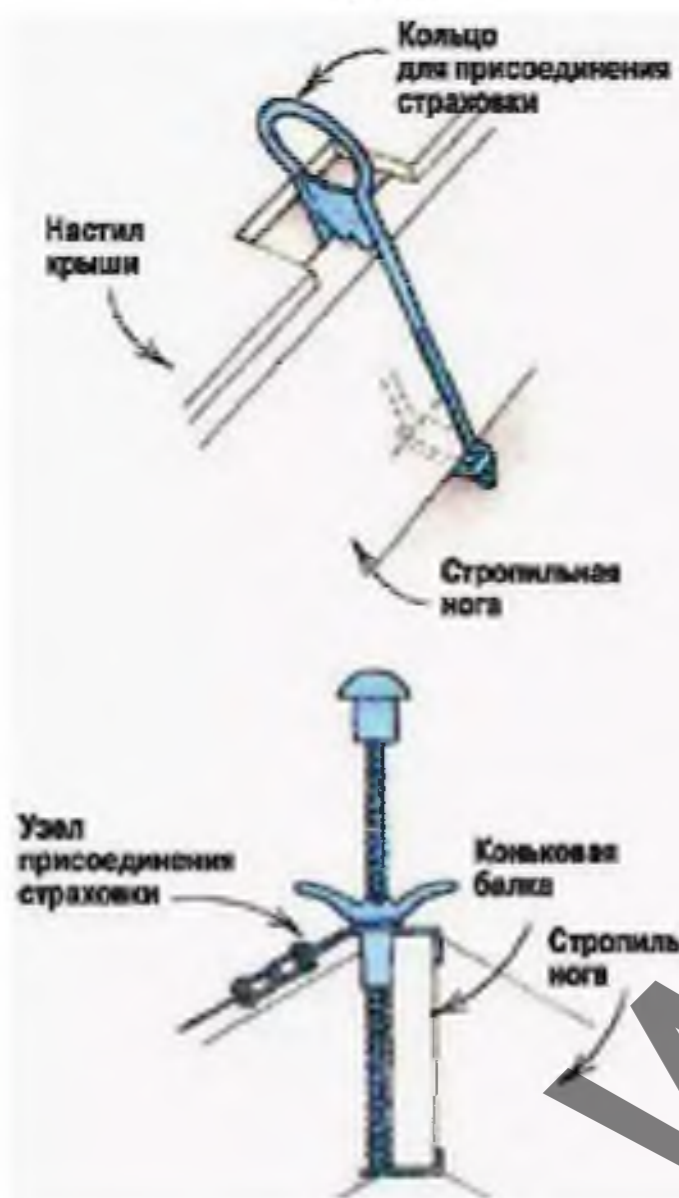
Варианты страховочных схем при работе на скатной кровле
