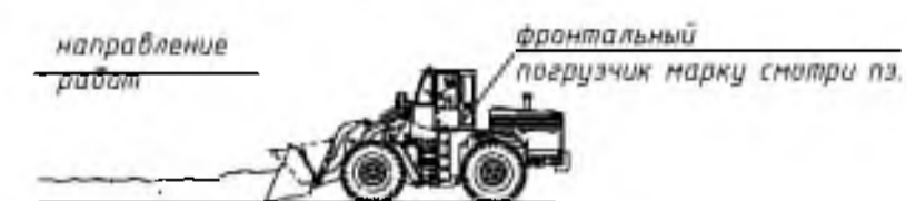
Выемка грунта погрузчиком
