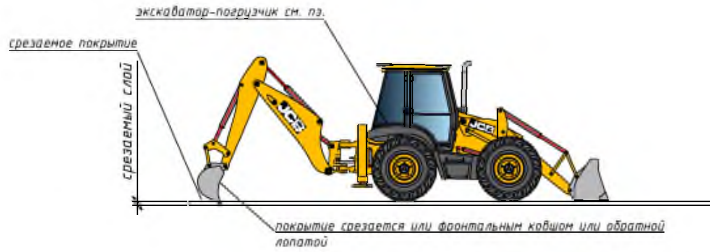
Схема демонтажа покрытий экскаватором
