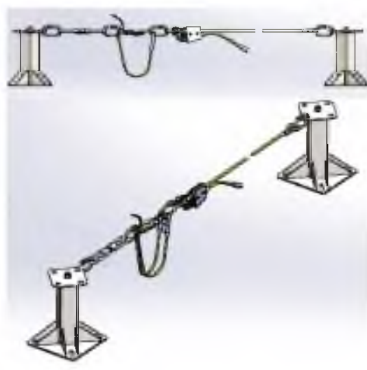
Схема устройства анкерной линии Анкерная линия Krok Моби-стил 10
