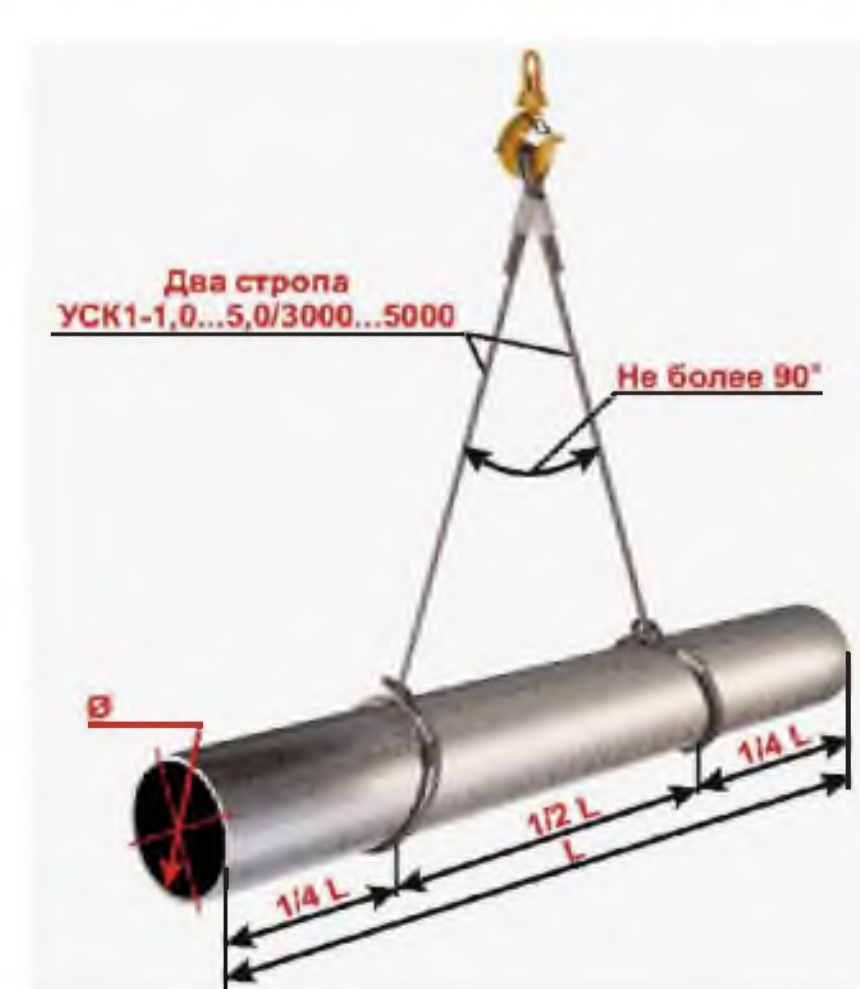
Схема стропки стальных труб d170мм
