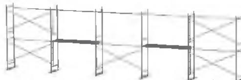
Одновременно с монтажом произвести крепление к стене при помощи регулируемого кронштейна и анкерного болта (16). См. схему крепления к стене.
