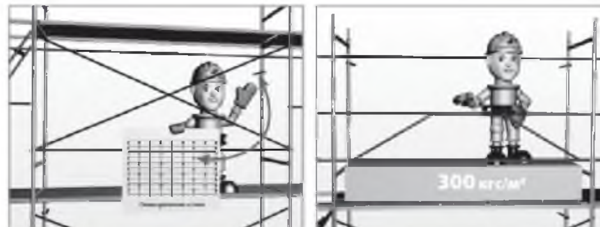
Фиксируйте леса к стене при помощи анкеровых креплений в соответствии со схемой, приведенной в паспорте лесов
