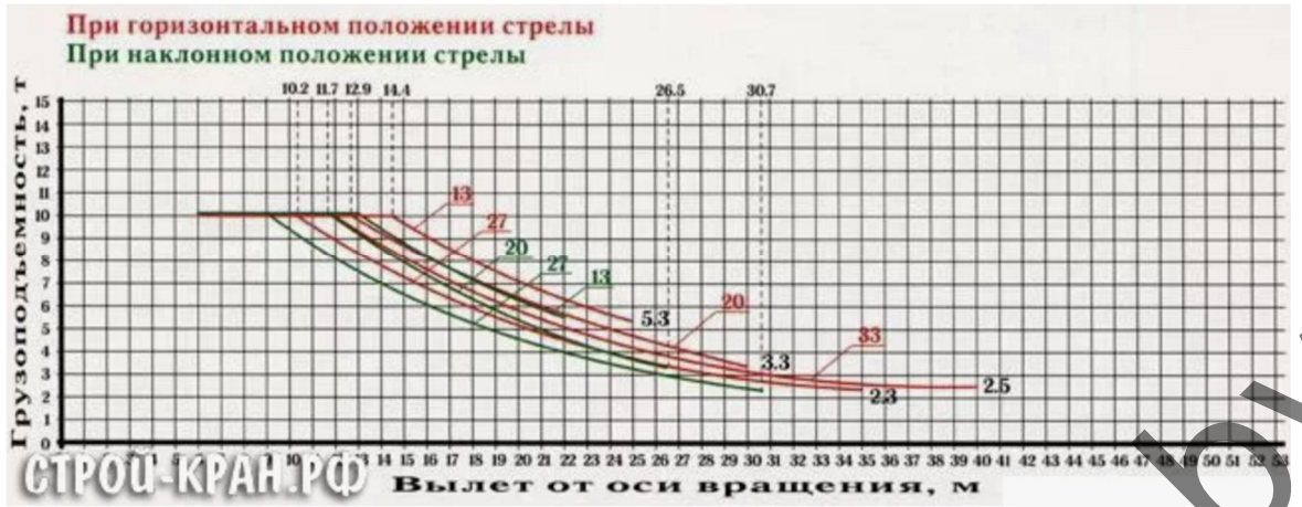
Рис. 7.2.2 Грузовые характеристики крана KBM401П
