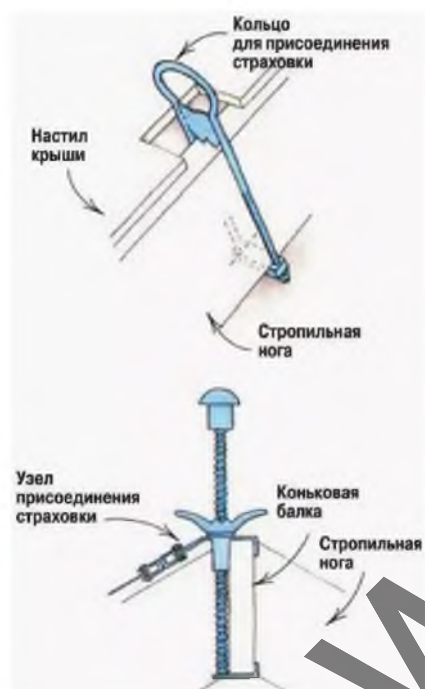
Варианты страховочных схем при работе на скатной кровле
