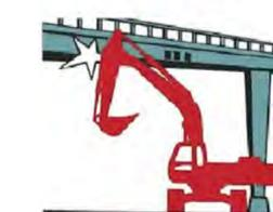
Осмотритесь, нет ли в зоне действий стрелы и ковша экскаватора сооружений и конструкций, препятствующих работе и опасных при соприкосновении с ними.
