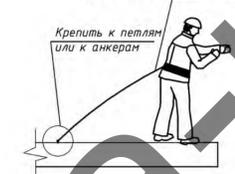
**Важно!** Работы производить только со страховочной привязью. Точки крепления определяет мастер/прораб в зависимости от ситуации. Рабочие места и площадки к ним, расположенные на перекрытиях, покрытиях на высоте 1,3 м и более и на расстоянии менее 2 м от границы перепада по высоте, должны быть ограждены предохранительными или страховочными защитными ограждениями, а при расстоянии более 2 м - сигнальными ограждениями. (Высота ограждения не менее 1,2м).
