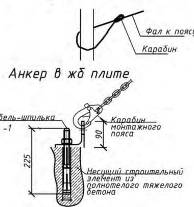
Порядок крепления разжимного анкера в бетоне
