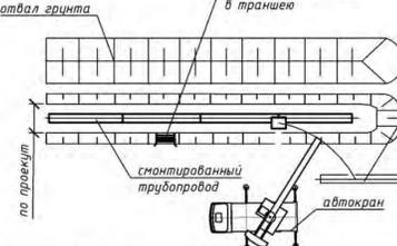
Схема безопасности при работе с вибратором
