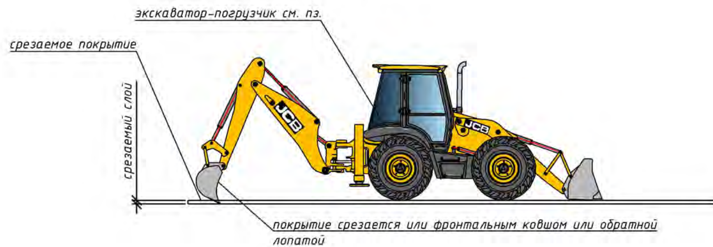
Схема демонтажа покрытий экскаватором
