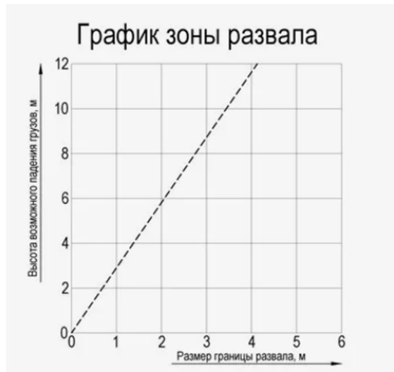
График зоны развала сносимого здания
