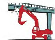
Осмотритесь, нет ли в зоне действия стрелы и ковша экскаватора сооружений и конструкций, препятствующих работе и опасных при соприкосновении с ними.
