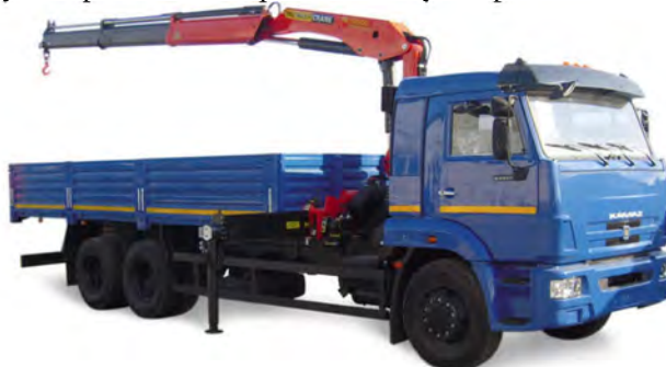
Автомобиль с краном-манипулятором.
