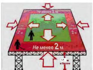
на перепадах высот, которые не имеют ограждения, следует использовать страховочную привязь при работе на расстоянии 2м от перепада высот
