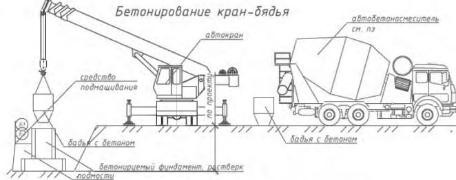
**Бетонирование с автобетоносмесителя**
