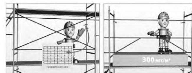
Фиксируйте леса к стене при помощи анкерных креплений в соответствии со схемой, приведенной в паспорте лесов
