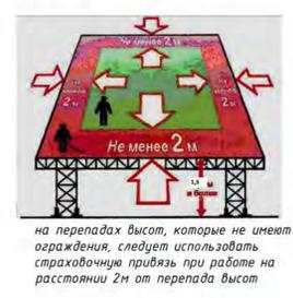
**Важно!** Работы производить только со страховочной привязью. Точки крепления определяет мастер/прораб в зависимости от ситуации. Рабочие места и проходы к ним, расположенные на перекрытиях, покрытиях на высоте 1,3 м и более и на расстоянии менее 2 м от краев перепада по высоте, должны быть ограждены предохранительными или страховочными защитными ограждениями, а при расстоянии более 2 м - сигнальными ограждениями (высота ограждения не менее 1,2м).
