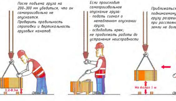
Схема строповки оборудования строповка двумя текстильными стропами типа СТТ-2.0
