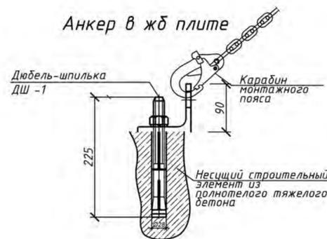
Монтаж страховочных систем производить согласно инструкции изготовителя. (допускается применять только специальные страховочные анкерные устройства)
