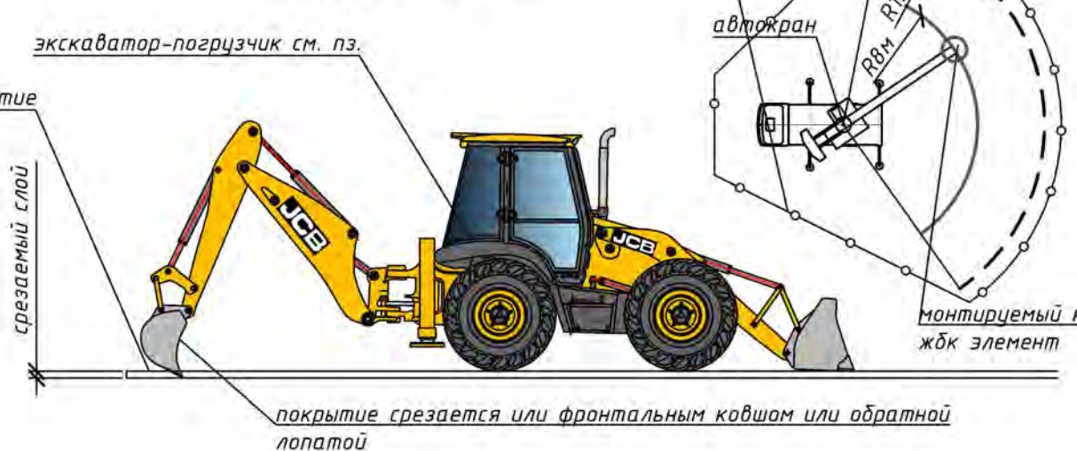
Схема демонтажа покрытий экскаватором
