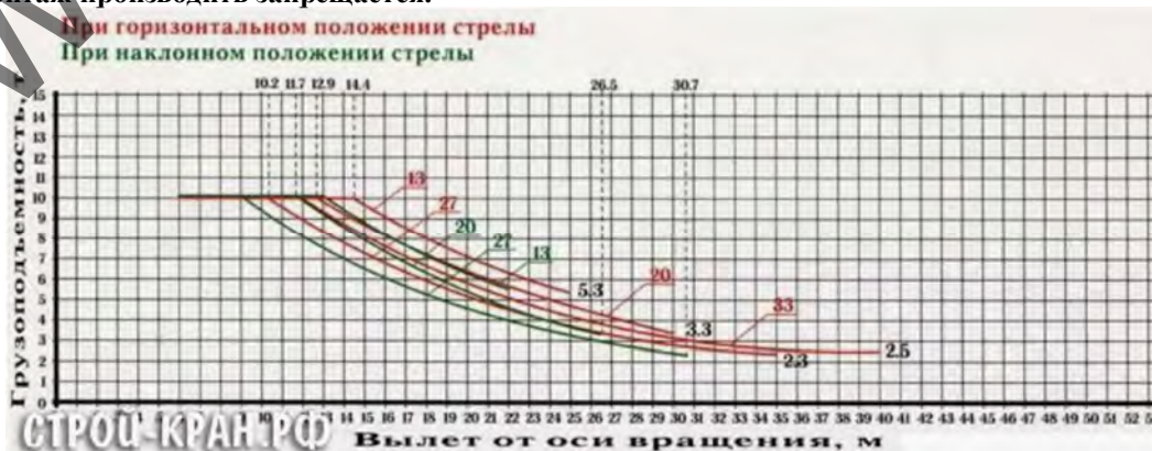
Характеристики башенного крана КБМ401П горизонтальное положение
