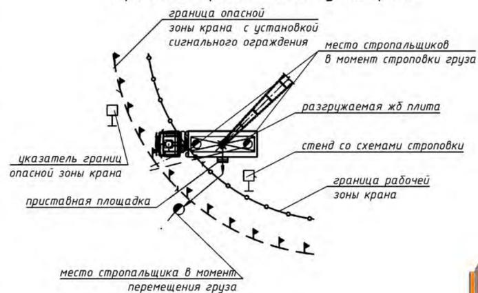
Схема монтажа стропильной фермы
