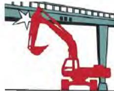
Осмотритесь, нет ли в зоне действия стрелы и ковша экскаватора сооружений и конструкций, препятствующих работе и опасных при соприкосновении с ними.
