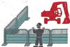
Проверьте, установлено ли сигнальное ограждение рабочей зоны сзади с боков в радиусе действия ковша экскаватора. Если ограждение не установлено, следует его установить!
