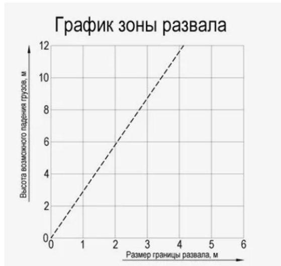
График зоны развала сносимого здания
