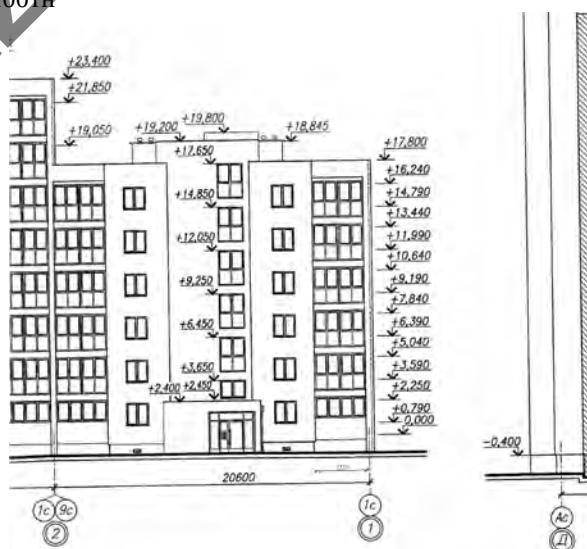
Фасад мертвой зоны которую нужно монтировать автокраном
