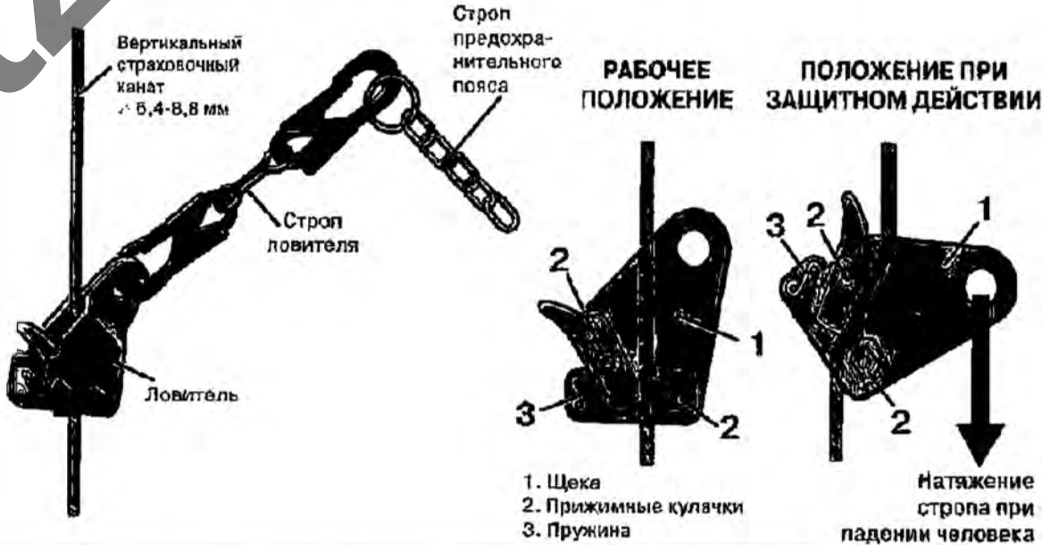
Схема устройства ловителя
