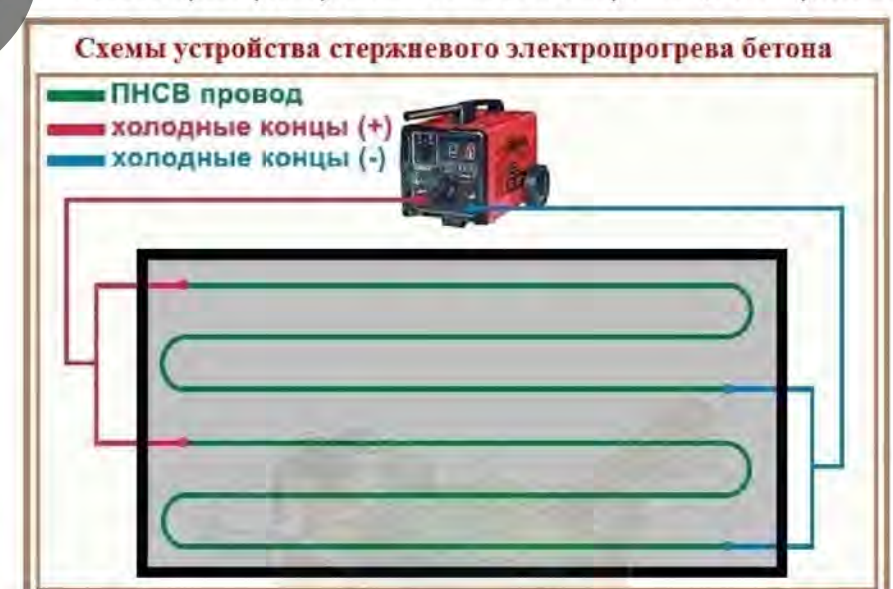
Схема электропрогрева бетона вертикальными электродами
