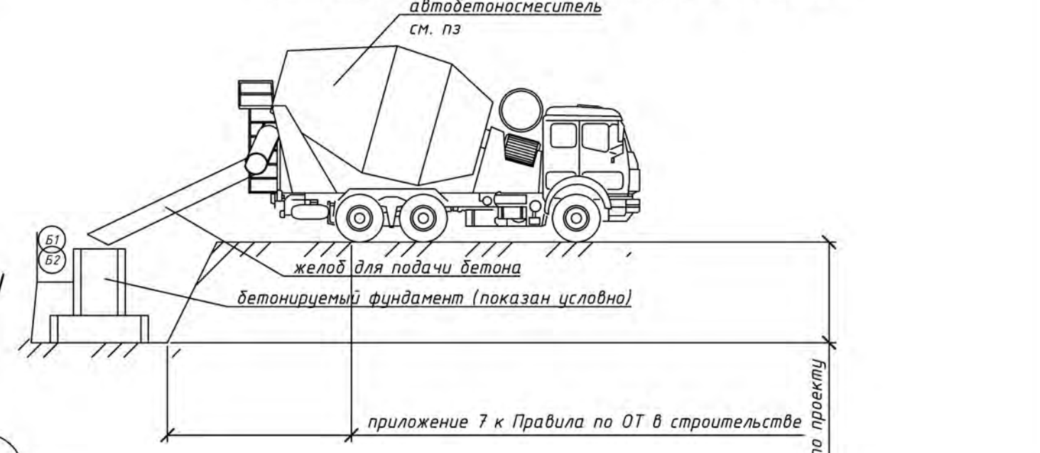
Бетонирование с автобетоносмесителя
