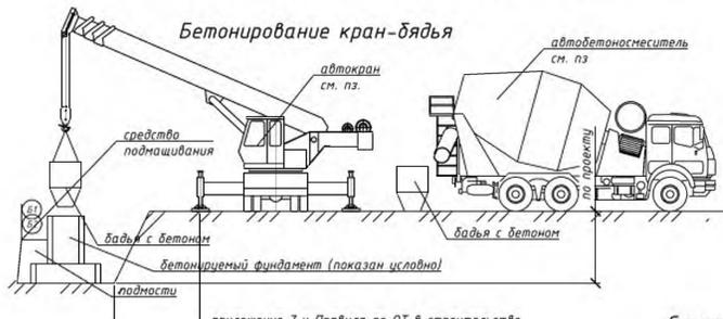
Бетонирование с автобетоносмесителя
