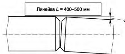
Рисунок 4 — Отклонение (перелом) собранного под сварку соединения от прямой линии
