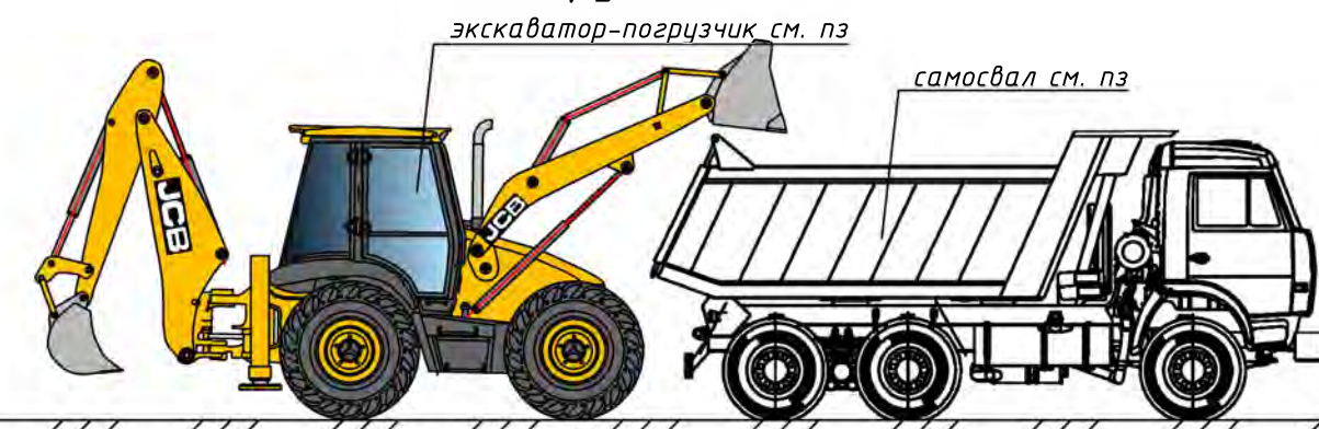
Погрузка грунта экскаватором - погрузчиком в самосвал
