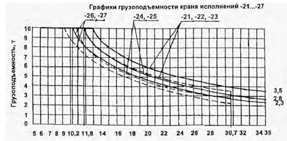
Грузовые характеристики крана КБМ401П
