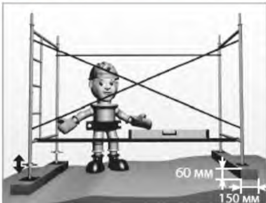
При помощи винтовых опор добейтесь строго горизонтального положения первого яруса лесов
